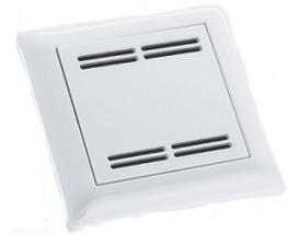
Der KNX-Enthalpieregler enthält ein Temperatur-/ Feuchtemesssystem, auf dessen Grundlage weitere Luftzustandsgrößen (z.B. absolute Feuchte, Taupunkttemperatur, Enthalpie) errechnet und ausgegeben werden. Weiterhin verfügt der Enthalpieregler über zahlreiche Regelfunktionen zur Steuerung und Überwachung von Heizungs-, Lüftungs- und Klimaanlage.
